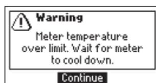
本器が過熱しているか、仕様上の精度の範囲内で作動するには温度が低すぎます。
