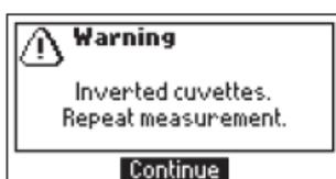
サンプルと基準液のガラスセルが逆です。ガラスセルを正しい順に使用して測定を行って下さい。
