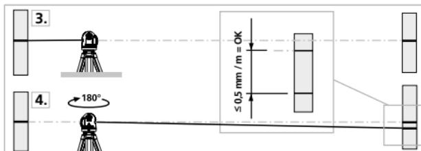
! Wanneer het verschil tussen punt A2 en A3 groter is dan de aangegeven tolerantie, nl. 0,35 mm / m, is een kalibratie nodig. Neem hiervoor contact op met uw vakhandelaar of met de serviceafdeling van UMAREX-LASERLINER.
