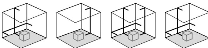
**!** Voor de horizontale en verticale nivellering moet de transportbeveiliging gedeactiveerd zijn. Zodra het apparaat zich buiten het automatische nivelleerbereik van 3° bevindt, knipperen de laserlijnen en klinkt een signaal. Positioneer het apparaat zodanig dat het zich binnen het nivelleerbereik bevindt.
