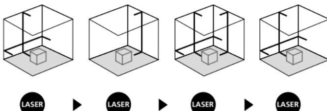
! Vid horisontell och vertikal nivellering måste transportsäkringen lossas. Så fort enheten befinner sig utanför det automatiska nivelleringsområdet på 3° blinkar laserlinjerna och en signal ljuder. Positionera enheten på ett sådant sätt, att den befinner sig inom nivelleringsområdet.
