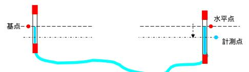
まず、例1)のように水平点を確認します。その後、水平点にあるシリンダーを移動させます。 計測点が基点より下にある場合は計測する方のシリンダー水位が上がります。 基点となるシリンダーのメモリをチェックして、水平点との差を測ってください。
