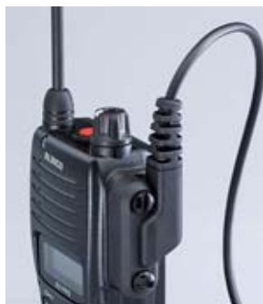
専用イヤホンマイクを 接続するネジ止め式ポート
