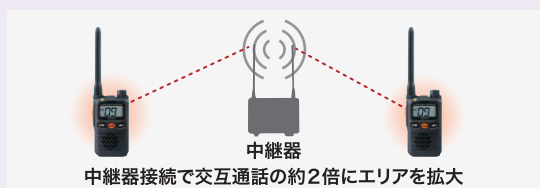
中継器接続で交互通話の約2倍にエリアを拡大
