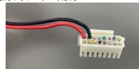
電源用以外の配線をカットした写真
