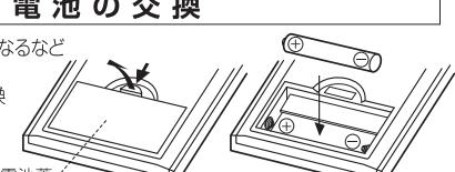
①本体背面の電池カバーを矢印の方向に押しながら持ち上げて取り外してください。
