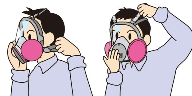
片手で面体を押さえたまま、下側の左右のハーネスを後ろに引くようにして調整します。次に上側の左右のしめひもを調整します。この時、面体がつぶれるなどの変形を起こすほど強くしめすぎないように注意してください。
