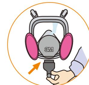
フィットチェックツールがない場合は、排気弁カバーの排気口を手のひらで塞ぐことで、ユーザーシールチェックを行えます。
