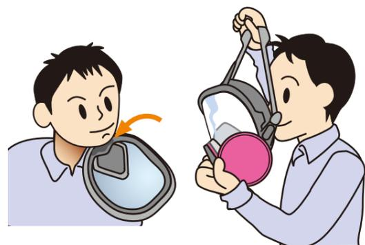
片手で面体を持ち、もう一方の手でしめひもの下部を持ちます。アゴがマスクに乗るようにマスクの位置を調整しながら、ハーネスを引っぱりあげるようにして、頭からかぶります。
