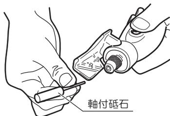
4. 片ロスパナを使って確実にコレットチャックを締付け、軸を固定します。
