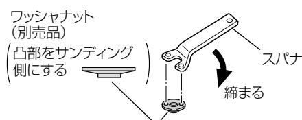
**2** サンディングディスクの上から、ワッシャナットの凸部をサンディングディスクの穴に合わせ、スピンドルに取付けます。
