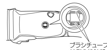
**注** カーボンブラシのツメは、必ずブラシチューブ外側の接触部に挿入してください。
