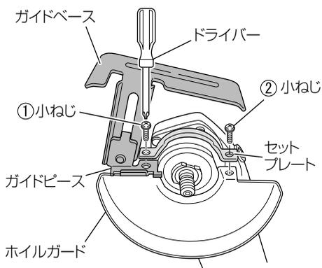
**2** ガイドピースをホイルガードとセットプレート間に挟み込み、①小ねじをしっかりと締付けます。
