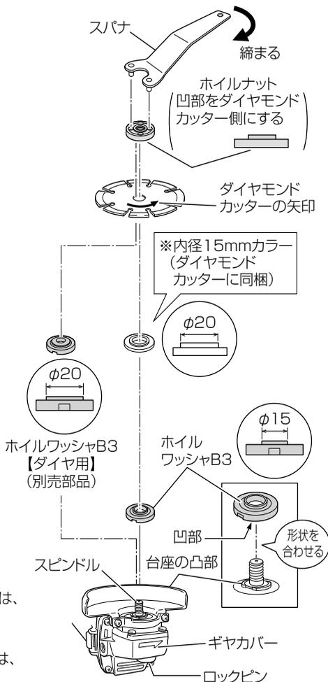
※ホイルワッシャB3(付属品)を使用するときは、ダイヤモンドカッターに同梱されている内径15mmカラーを使用します。
