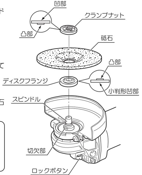
6. ロックボタンを押してスピンドルを固定し、カニ目スパナでクランプナットを十分に締付けます。
