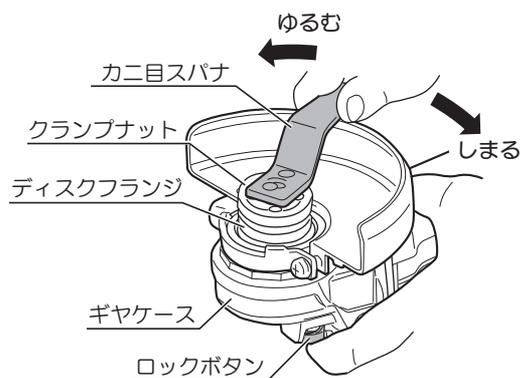
3. ディスクフランジの小判形凹部をスピンドルの切欠部に合わせて取付けます。
