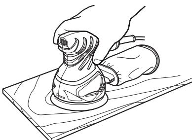
ハウジング上部を握り、サンドペーパーが加工面に一様に当たるよう機体を加工面に軽く押しつけます。必要以上に強く押しつけると、モーターに無理がかかり、サンドペーパーの寿命を短くするだけで、研摩能率を悪くします。
