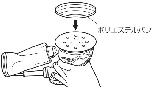
○サンドペーパーと同様に取付けはマジック式ですので、パッドに押しつけるだけで取付けできます。
