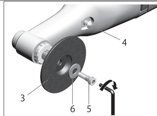
ディスクパッドの取り替えは、ストッパーボタン④を押さえながら、付属のL型レンチでボルト⑤を緩め、ワッシャ⑥と共に取り外します。このとき、ワッシャ⑥を紛失しないように注意してください。交換用のディスクパッドを装着し、ワッシャ⑥ボルト⑤の順でストッパーボタン④を押さえながら付属のL型レンチで締め付けます。
