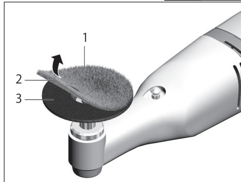
③のディスクパッドに各種先端工具①を取り付けます。各種先端工具①の裏面②はマジックテープ着脱式になっています。しっかり押さえつけ、取り付けてください。取り付け後は、必ず、試運転を行い、先端工具が確実に取り付けられていることを確認してください。
