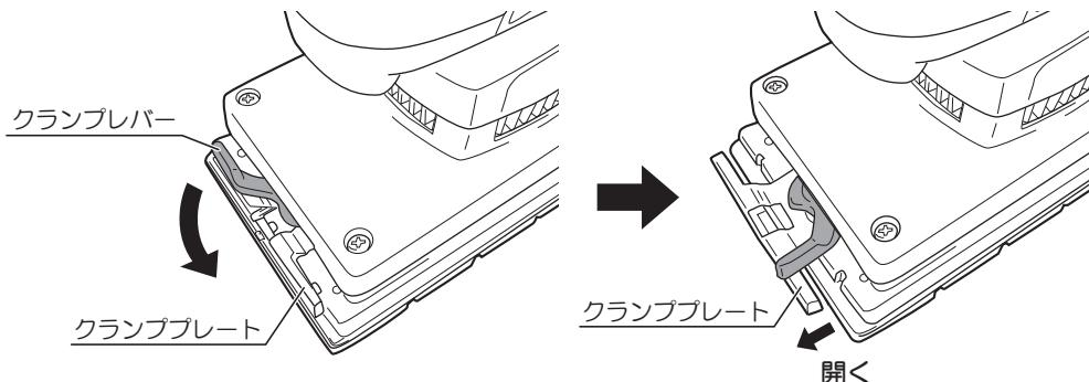
2. ベースとクランプレートの間に木工用ペーパーをさし込み、木工用ペーパーとパッドの幅を合わせるようにしてクランプレバーを矢印の方向に動かし、クランプレートを閉じます。
