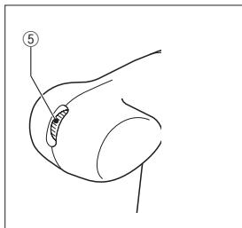
スピード調節ダイヤル (⑤) を調節することによって、作業に合わせた最適なスピードに設定することができます。
