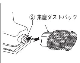
集塵ダストバック取付口 (②) の下側にある突起と、集塵ダストバック接続部の溝が合うように差し込みます。
