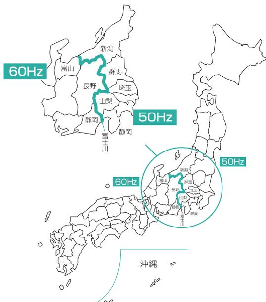
AC ボタンを約 1 秒押し、周波数 50Hz/60Hz を切り替えてください。
