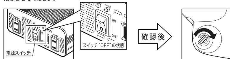
3. 本製品の電源スイッチを“ON”の状態にしてください。電源ランプが点灯し、通電を開始します。
