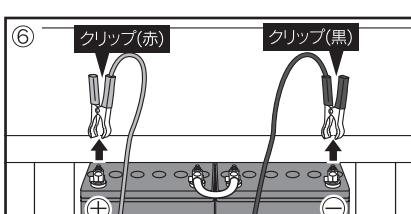
⑥バッテリーの①端子からバッテリー接続クリップ(黒)をはずす。バッテリーの②端子からバッテリー接続クリップ(赤)をはずす。
