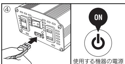
④本製品のUSB端子に使用するUSB機器の接続コードを接続し、使用するUSB機器の電源を「ON」にする。
