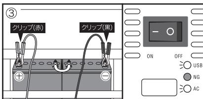
③バッテリー接続クリップ(赤)をバッテリーの $\oplus$ 端子に接続する。バッテリー接続クリップ(黒)をバッテリーの $\ominus$ 端子に接続する。接続が完了するとUSBランプが点灯してUSB電源が使用可能になる。
