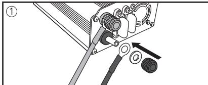
①バッテリー接続コードの $\oplus$ 丸端子(赤)を本製品背面のDC入力端子 $\oplus$ に接続する。バッテリー接続コードの $\ominus$ 丸端子(黒)を本製品背面のDC入力端子 $\ominus$ に接続する。
