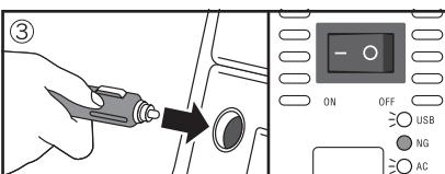
③本製品の電源プラグをアクセサリーソケットに接続すると、USBランプが点灯してUSB電源が使用可能になる。本製品のAC用電源スイッチを「ON」になると、ACランプが点灯してACコンセントが使用可能になる。
