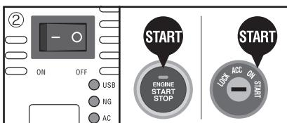
②本製品のAC用電源スイッチが「OFF」になっていることを確認して、エンジンスイッチを「ON」にする。
