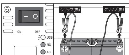
⑥本製品のAC用電源スイッチを「OFF」にし、バッテリーの $\ominus$ 端子からバッテリー接続クリップ(黒)をはずす。バッテリーの $\oplus$ 端子からバッテリー接続クリップ(赤)をはずす。
