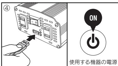
④本製品のUSB端子に使用するUSB機器の接続コードを接続し、使用するUSB機器の電源を「ON」にする。
