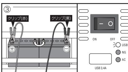
③バッテリー接続クリップ(赤)をバッテリーの①端子に接続する。バッテリー接続クリップ(黒)をバッテリーの②端子に接続する。接続が完了するとUSBランプが点灯してUSB電源が使用可能になる。
