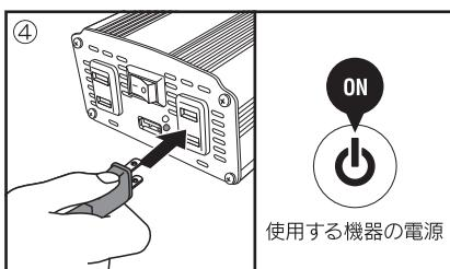
④本製品のACコンセントに使用する機器の電源プラグを接続し、使用する機器の電源を「ON」にする。
