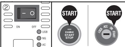
②本製品のAC用電源スイッチが「OFF」になっていることを確認して、エンジンスイッチを「ON」にする。
