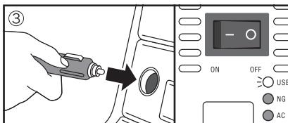
③本製品の電源プラグをアクセサリーソケットに接続すると、USBランプが点灯してUSB電源が使用可能になる。
