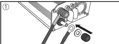
①アクセサリーソケット接続コードの①丸端子(赤)を本製品背面のDC入力端子④に接続する。
