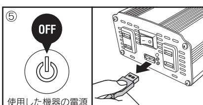
⑤使用後は使用したUSB機器の電源を「OFF」にし、本製品のUSB端子に接続している接続コードを抜く。
