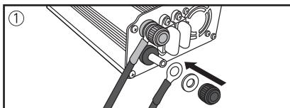
①アクセサリーソケット接続コードの $\oplus$ 丸端子(赤)を本製品背面のDC入力端子 $\oplus$ に接続する。
