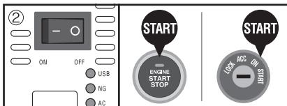
②本製品のAC用電源スイッチが「OFF」になっていることを確認して、エンジンスイッチを「ON」にする。
