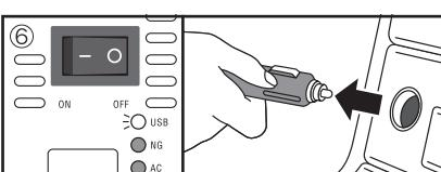
⑥本製品のAC用電源スイッチを「OFF」にし、アクセサリーソケットから本製品の電源プラグを抜く。
