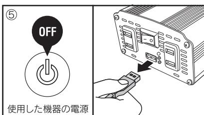
⑤使用後は使用したUSB機器の電源を「OFF」にし、本製品のUSB端子に接続している接続コードを抜く。
