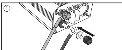
①バッテリー接続コードの①丸端子(赤)を本製品背面のDC入力端子①に接続する。バッテリー接続コードの②丸端子(黒)を本製品背面のDC入力端子②に接続する。
