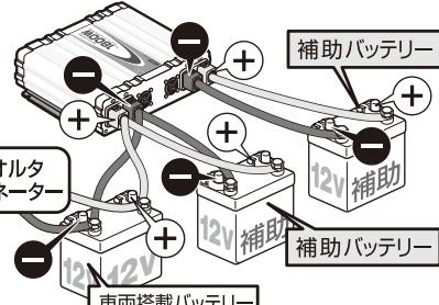
※補助バッテリーを使用する際は、本製品と車両搭載バッテリー間の接続ケーブルを別途用意してください。
