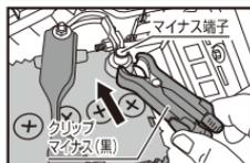
② プラス(赤)のクリップをバッテリーのプラス端子(+)に接続してください。
