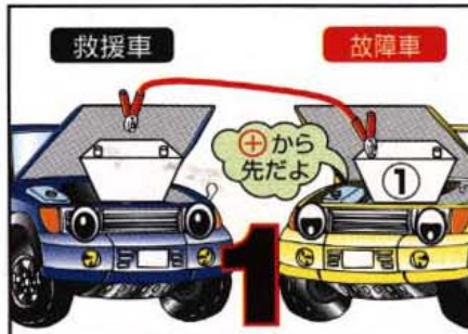
①故障車の⊕端子に接続します。
