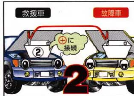
②故障車の⊕端子に接続したら片方を救援車の⊕端子に接続します。
