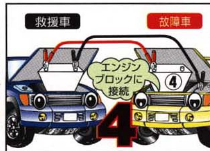
④救援車の⊖端子に接続したら片方を故障車のエンジンブロックに接続します。
