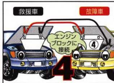
④救援車の ⊖ 端子に接続したら片方を故障車のエンジンブロックに接続します。
