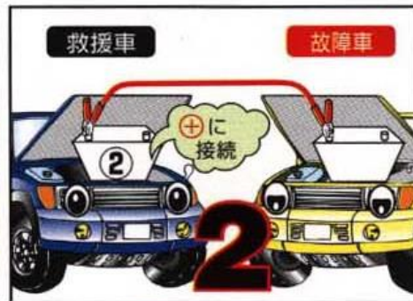
②故障車の ⊕ 端子に接続したら片方を救援車の ⊕ 端子に接続します。
