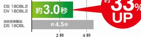
◎コンクリート穴あけ作業(HIGHモード/振動モード)
