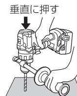
**注** ドリルマーク「△□□」で使用する際、回転が停止する操作を数秒間続けないようにしてください。モーターが故障する原因になります。
