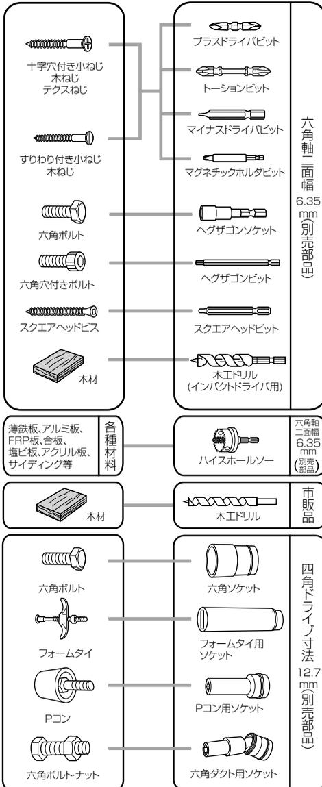
**注** 能力より小径のねじやボルトを締めると、ねじやボルトが切れる恐れがあります。また、能力より太径のねじやボルトを締めると締め付け不足になることがあります。
