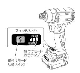
締付けモード切替機能の設定例
