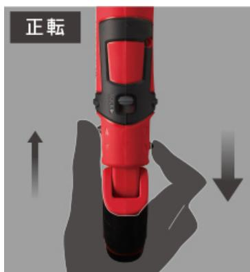
本体右側(上から見て)を手前に引けば「正転」。工具のトリガーを引くのと同じ操作感覚。
