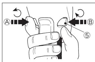
左図の方向から見て、正転／ロック／逆転スイッチ（⑤）をAから一杯に押すと正転します。スイッチをBから一杯に押すと逆転します。このスイッチを中央位置にセットしておくと、トリガースイッチがロックされて動かなくなります。使用しないときは、ロックをかけた状態にしておいてください。このスイッチの位置を替えるときは、必ずトリガースイッチを放してください。
