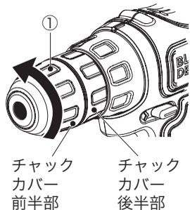
(1) 本製品にはキーレスチャック①が装備されています。チャックカバー後半部を押さえながら、前半部を反時計回りに回してチャックを開いてください。使用するビットを開いたチャックの中に20ミリ程度押し込んでください。
