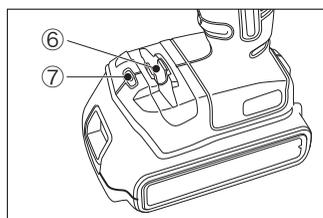
本製品にはLEDライト（⑦）が搭載されています。トリガースイッチを引くとLEDライトが点灯します。トリガースイッチを放すとLEDライトが消灯します。LEDライトは暗所の作業に最適です。また、本製品にはビットホルダー（⑥）が装備されています。六角軸タイプのビットを保持することができます。
