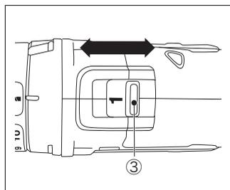
2段階スピード切り替えスイッチ（③）を後方（ポジション1）にスライドさせると低速／高トルクの設定になり、前方（ポジション2）にスライドさせると高速／低トルクの設定となります。
