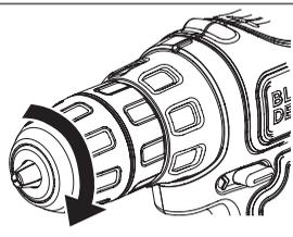
(2) チャックカバー後半部を押さえながら、前半部を時計回りに回してキーレスチャックを締めてください。キーレスチャックの3本の爪がビットを挟み込み、固定します。作業が終わったら、再びチャックカバー後半部を押さえながら、前半部を反時計回りに回し、ビットを取り外してください。
