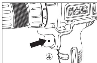
左図のように、無段変速トリガースイッチ（④）を引くと作動します。またトリガースイッチを放せば止まります。トリガースイッチには無段変速機能が組み込まれていますので、深く引くと高速、浅く引くと低速というように速度を調節できます。作業の内容に合わせてトリガーの引き具合で速度を調節できるので大変便利です。
