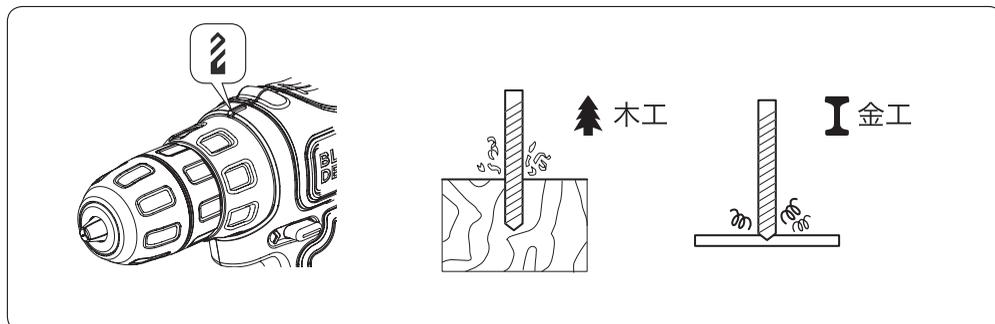
穴あけ作業には、11段階目のクラッチポジション“2”の位置にクラッチをセットしてください。この位置ではトルク調整装置が作動しません。
