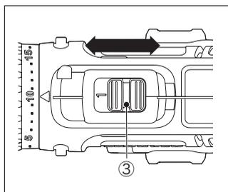
2段階スピード切り替えスイッチ (3) を後方 (ポジション1) にスライドさせると低速/高トルクの設定になり、前方 (ポジション2) にスライドさせると高速/低トルクの設定となります。
