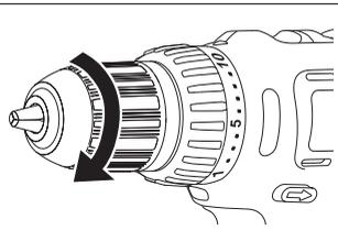
(2) その後、チャックカバーを時計回りに回してキーレスチャックを締めてください。キーレスチャックの3本の爪がビットを挟み込み、固定します。作業が終わったら、再びチャックカバーを反時計回りに回し、ビットを取り外してください。
