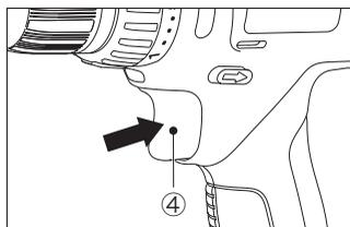
左図のように、無段変速トリガースイッチ (4) を引くと作動します。またトリガースイッチを放せば止まります。トリガースイッチには無段変速機能が組み込まれていますので、深く引くと高速、浅く引くと低速というように速度を調節できます。作業の内容に合わせてトリガーの引き具合で速度を調節できるので大変便利です。
