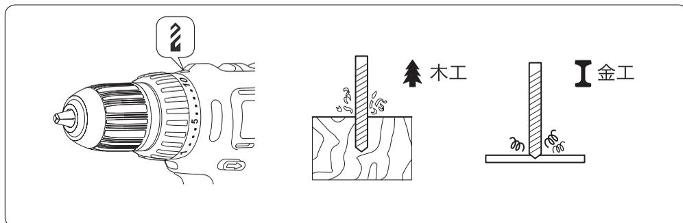
穴あけ作業には、21段階目のクラッチポジション“⚡”の位置にクラッチをセットしてください。この位置ではトルク調整装置が作動しません。
