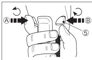
左図の方向から見て、正転/ロック/逆転スイッチ (5) をAから一杯に押すと正転します。スイッチをBから一杯に押すと逆転します。このスイッチを中央位置にセットしておくと、トリガースイッチがロックされて動かなくなります。使用しないときは、ロックをかけた状態にしておいてください。このスイッチの位置を替えるときは、必ずトリガースイッチを放してください。
