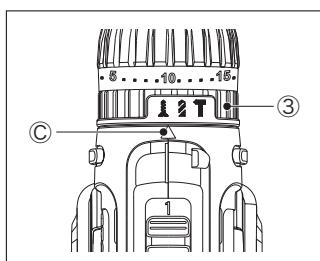
本機にはモードを切り替えする機能が搭載しています。モード切替リング (③) を回し、希望する作業に応じて④の位置にマークを合わせて使用してください。
