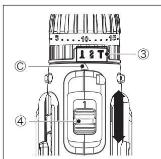
コンクリートへの穴あけ作業には、振動ドリル機能を使用してください。振動ドリルモードへ切り替えは、モード切替リング (③) を回し、④の位置に“T”を合わせてください。また、2段階スピード切り替えスイッチ (④) を“2”に切り替えてください。
