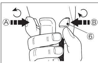
左図の方向から見て、正転／ロック／逆転スイッチ（⑥）をⒶから一杯に押すと正転します。スイッチをⒷから一杯に押すと逆転します。このスイッチを中央位置にセットしておくと、トリガースイッチがロックされて動かなくなります。使用しないときは、ロックをかけた状態にしておいてください。このスイッチの位置を替えるときは、必ずトリガースイッチを放してください。
