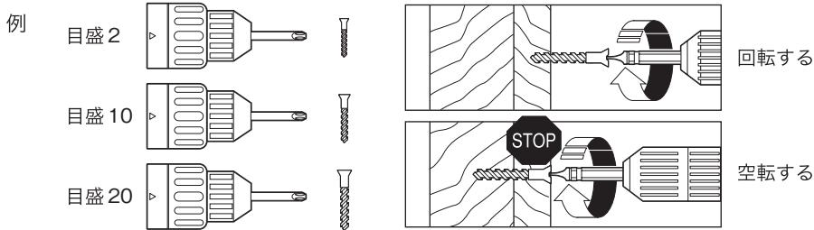
ネジ締め作業には、モード切替リングを回し、“”にセットしてください。(10ページのモード切替参照) 太いネジには高いトルク設定が必要ですが、細いネジにはあまり高いトルクはかえってネジを痛めます。何本かのネジ締めをする時に、最初の一本目でネジの頭が板とピッタリ平面になるところで回転が止まるようなトルクを見つけてそのトルクに設定しますと、二本目以後のネジ締めで平面を出すのが容易になります。
