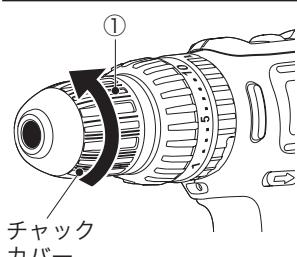
(1) 本製品にはキーレスチャック（①）が装備されています。製品本体を押さえながら、チャックカバーを反時計回りに回してチャックを開いてください。使用するビットを開いたチャックの中に20ミリ程度押し込んでください。
