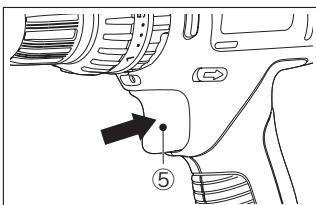
左図のように、無段変速トリガースイッチ（⑤）を引くと作動します。またトリガースイッチを放せば止まります。トリガースイッチには無段変速機能が組み込まれていますので、深く引くと高速、浅く引くと低速というように速度を調節できます。作業の内容に合わせてトリガーの引き具合で速度を調節できるので大変便利です。
