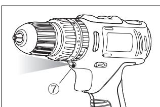
本製品にはLEDライト（⑦）が搭載されています。トリガースイッチを引くとLEDライトが点灯します。トリガースイッチを放した後、約20秒後にLEDライトが消灯します。LEDライトは暗所の作業に最適です。
