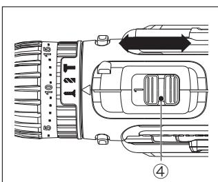
2段階スピード切り替えスイッチ（④）を後方（ポジション1）にスライドさせると低速／高トルクの設定になり、前方（ポジション2）にスライドさせると高速／低トルクの設定となります。
