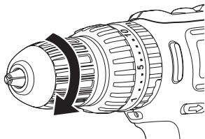
(2) 製品本体を押さえながら、チャックカバーを時計回りに回してキーレスチャックを締めてください。キーレスチャックの3本の爪がビットを挟み込み、固定します。
