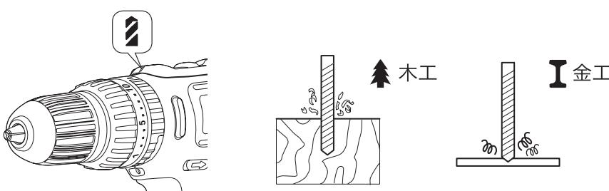
木工や金工への穴あけ作業には、モード切替リングを回し、“”にセットしてください。(10ページのモード切替参照) この位置ではトルク調整装置が作動しませんので、穴あけ作業で使用する時は、モーターの負荷に注意して作業を行ってください。
