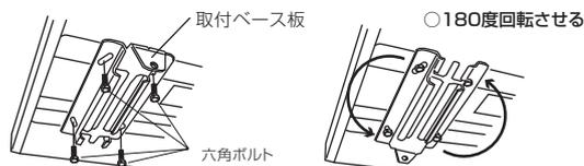
取付ベース板を固定している六角ボルトを外します。
