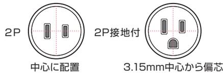
コンセントの差込み孔位置は2Pコンセントは中心に、2P接地付コンセントは3.15mm偏芯しているため、**防雨型2P接地付コンセントに防雨型2Pプラグは接続できません。**また無理に押し込んで接続しても嵌合部にすき間ができ、コンセント内部に水が浸入します。新開発の**兼用防雨型コンセント**は独自の機構で防雨型2Pプラグを接続してもすき間なくピッタリはまります。
