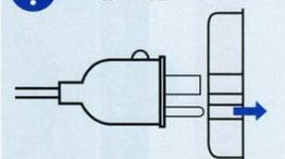
アースピンをロックして差込みます。アースピンはコンセントの接地極に挿入されて接続。
