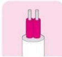
電源コードには、社団法人日本配線器具工業会規格 (JWDS0010) に適合した二重被ふくコードを採用していますので、断線や被ふく破れによる感電・火災の防止に有効
