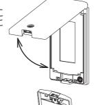
※カバーは図の 角度以上に開か ないでください。 破損します。
