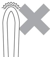
※直角曲げなど、最小曲げ半径以下に曲げないでください。
