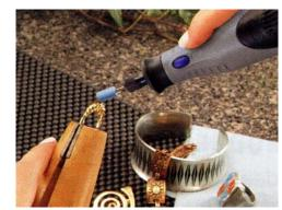
●金属、石材、セラミックの表面仕上げ、傷の磨きに。
