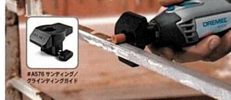
サンディング/グラインディングガイド(別売)によって研削・研磨作業時の操作性が向上。安定した面取り作業を実現。深さ調整可能。
