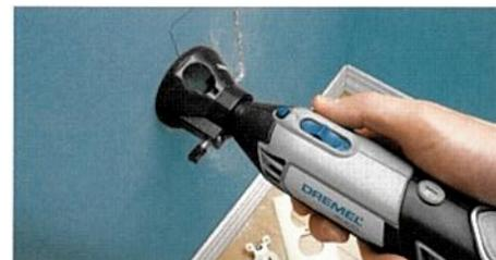
カッティングガイドを使うことで、木材、プラスチック、グラスファイバーなどの壁や板に穴を開けたり、くり抜き加工が可能。最大切り込み深さ19mm。
