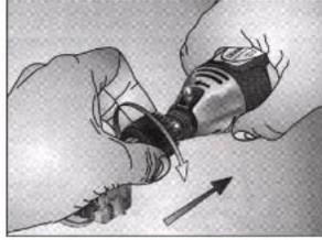
損傷しない様に締め込みすぎないでください。
