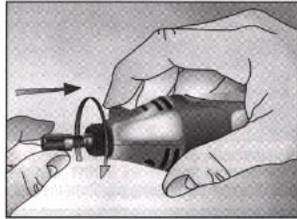
5. 回転工具にアタッチメントをねじ込み、ハウジングにしっかり止めます。(手締めのみ)
