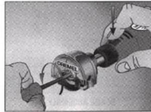
3. アタッチメントのガードを押し上げてマンドレルアーバーにブレードをおきます。矢印のある方を表にしてください。ブレードの向きが上部ガードと同じ方向に向いている事を確認してください。
