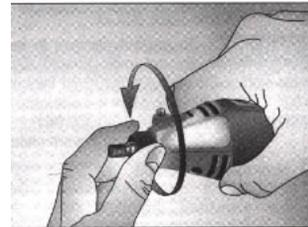
4. ドライブアダプターをモーターシャフトに差し込み、締め付けます。
