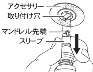
3. スリーブを片手で引き下げたまま、もう片方の手でマンドレル先端のロック部形状とアクセサリーの取り付け穴形状を合わせてアクセサリーをマンドレルの上に置きます。
