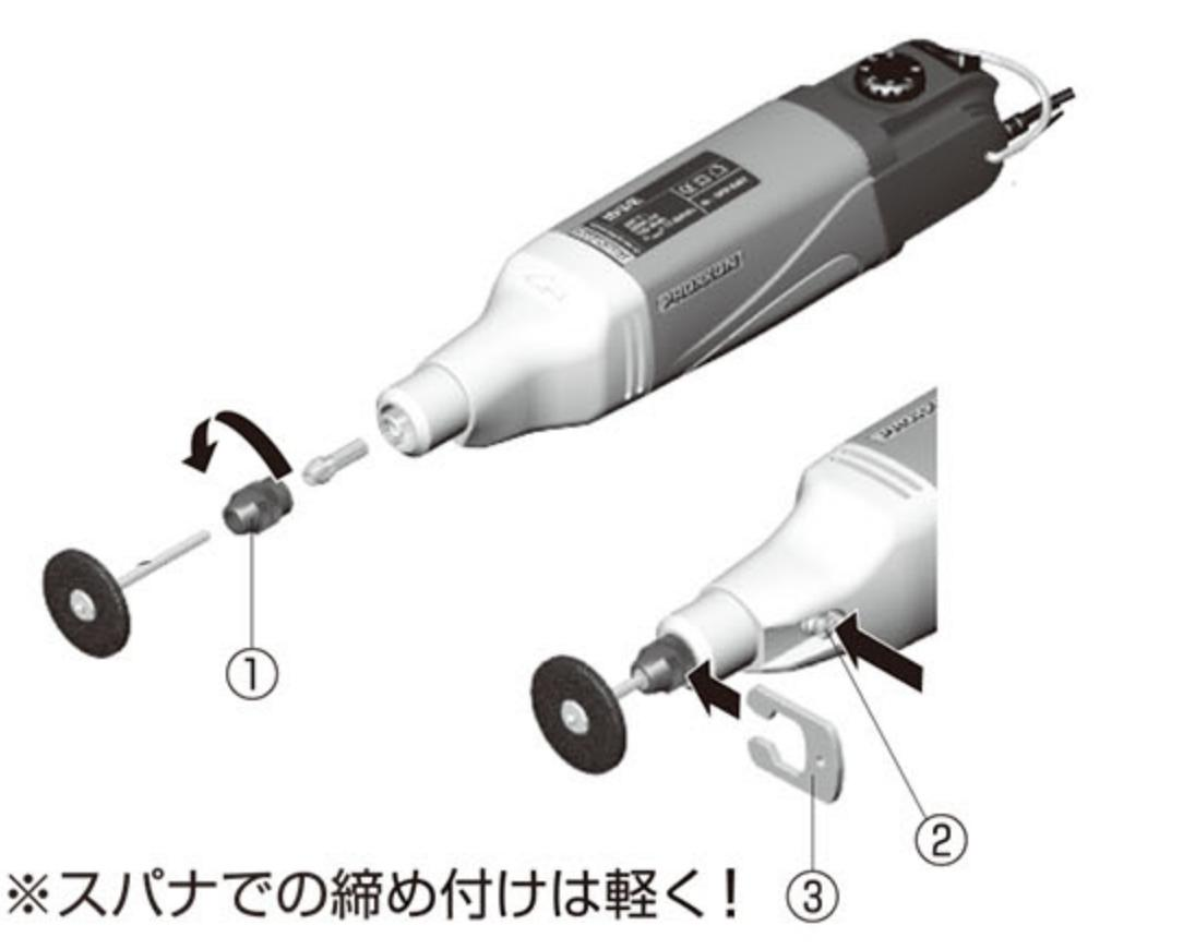
②のストッパーを軽く押さえながら、①のチャック部を指で回し、回転軸が固定される位置を探し、固定します。そのまま、②のストッパーを押さえ、付属のスパナ③でチャック部①のカバーをゆるめます。コレットチャック交換時は図のようにカバーを取り外し、コレットチャックを交換してください。
