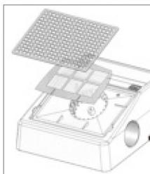
フィルターは交換可能です。フィルターの目がつまってくるので、集塵能力が低下しますので、使用後の清掃、交換を行って下さい。交換される際は下記、専用別売品、集塵テーブル用交換フィルターを投入をお求め下さい。
