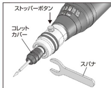
ストッパーボタンを軽く押さえながら、チャック部を指で回し、回転軸が固定される位置を確認します。先端ビットを取り付ける場合は、付属のスパナでコレットカバーをしっかりと締め付け、固定します。
