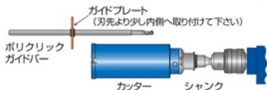
4) 電動機を回転させた状態で、カッターをゆっくりと穴あけ対象物に押し当てて下さい。カッターが穴あけ対象物に接した後、切削が安定するまでゆっくりと切り込んで下さい。
