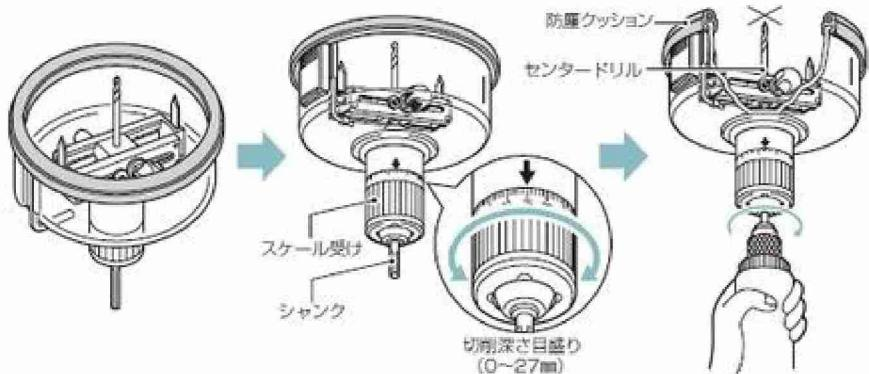
①フレームを移動させ径を調整して下さい。
