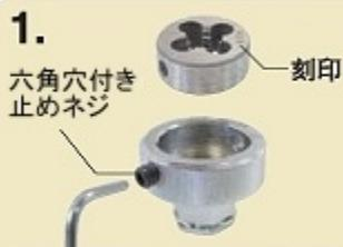
ダイスの刻印が見えるようにネジ修正アダプター本体に入れ、止めネジで固定する。
