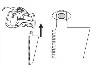
(2) 本体下側よりブレード（刃）に開いた穴を、ブレードロック（楕円）軸に合わせて差し込みます。
