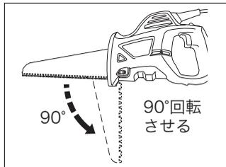
(2) ブレード取り外しボタンを押した状態で、ブレード（刃）を図のように90度回転させてください。
