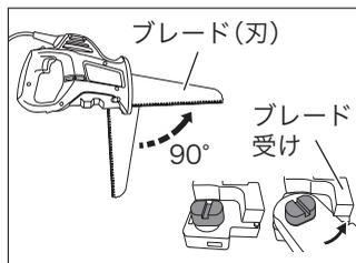
(3) ブレード（刃）がブレードロック（楕円）軸にしっかりとハマった状態で、ブレード（刃）を左図のように90°回転させ取り付けます。
