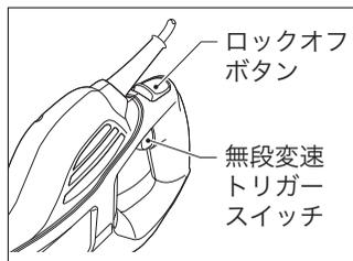
本機には無段変速トリガースイッチが装備されており、トリガースイッチの引き加減で変速します。切り始めと切り終り時のストローク数や切断速度をゆっくりすることで安全に作業をすることができます。
