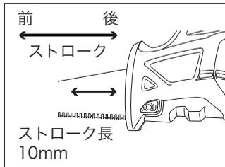
ブレード取り外しボタンは押せるが、ブレード（刃）が回転しない。ブレード（刃）を後方にある状態にしてから、再度ブレード取り外しボタンを押しブレード（刃）の取り外しを行ってください。
