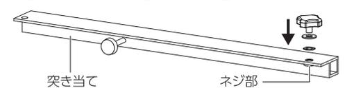
●突き当ての取り付け方(カッティング定規の状態から丸ノコガイド定規へ)
